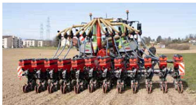
Es handelt sich um eine 12-reihige-Im Einsatz: Einzelkornsähmaschine aus dem Hause Mascar, Multiflex Cromina Smart-Drive mit Fronttank.
